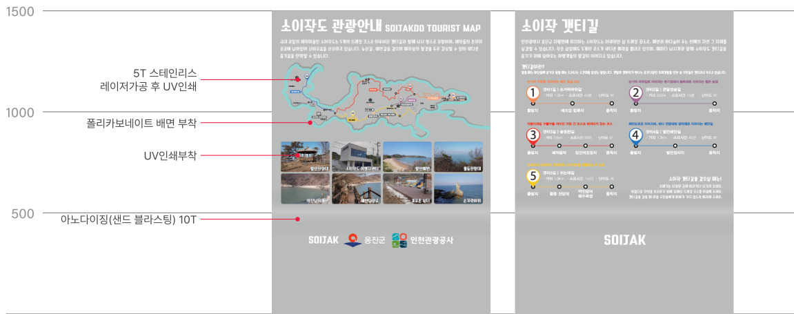
제품 상세정보 | · 안내판 : 스테인리스 (샌드 블라스팅 처리 및 아노다이징 마감) 1080x1500
